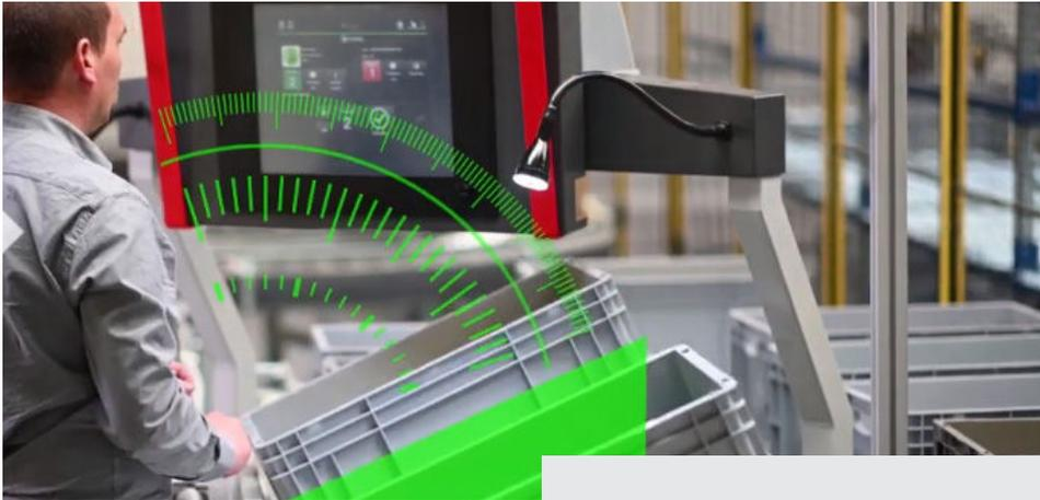
**Inclinaison des contenants :** ce système permet une réduction des contraintes sur les épaules et sur le buste. L'opérateur n'a pas besoin de se pencher pour saisir les produits, ni pour les déposer. Les mouvements sont ainsi restreints à la zone de confort du préparateur.
