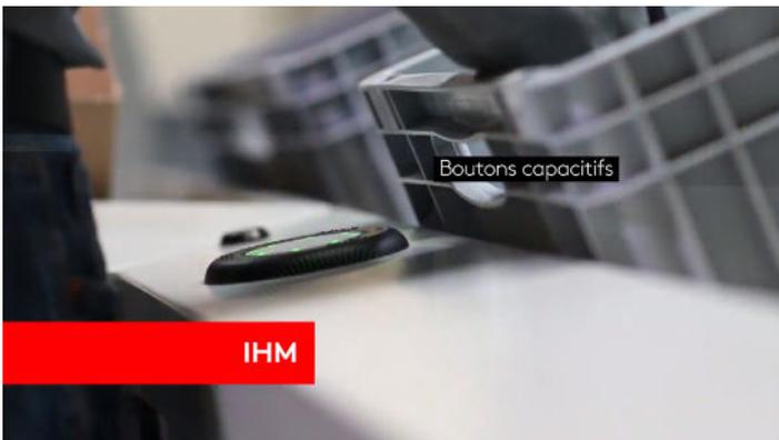
**Bouton de validation capacitif :** un simple effleurement permet de valider l'opération. Positionné à hauteur de hanche, l'effort est minimal.
