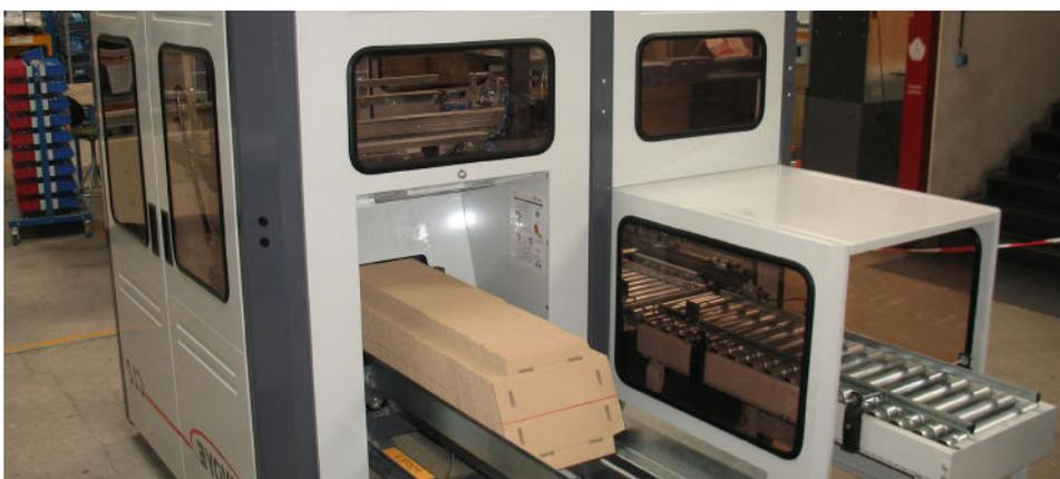
**La gamme de colis sécurisés PAC 600 :** ces machines formeurs permettent de concevoir un emballage très résistant qui se complète d'un calage par film thermo rétractable. La pose de coiffe plutôt que l'usage de rabats diminue à elle seule 10% de la surface du carton.
