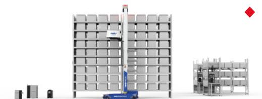
◆ **2 or 3-dimension mobile robots:** generalmente costituito da vassoi con un unico formato, il sistema di stoccaggio è servito da robot mobili in grado di muoversi su 2 o 3 assi per portare i prodotti direttamente alle stazioni di picking.
