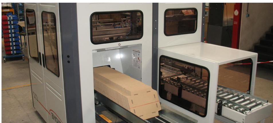
**La gamma PAC600 per colli sicuri:** queste macchine formatrici consentono di progettare imballaggi molto resistenti, completati dall'incuneamento mediante film termoretraibile. La semplice aggiunta di un coperchio, invece di utilizzare le alette, riduce l'area di cartone del 10%.
